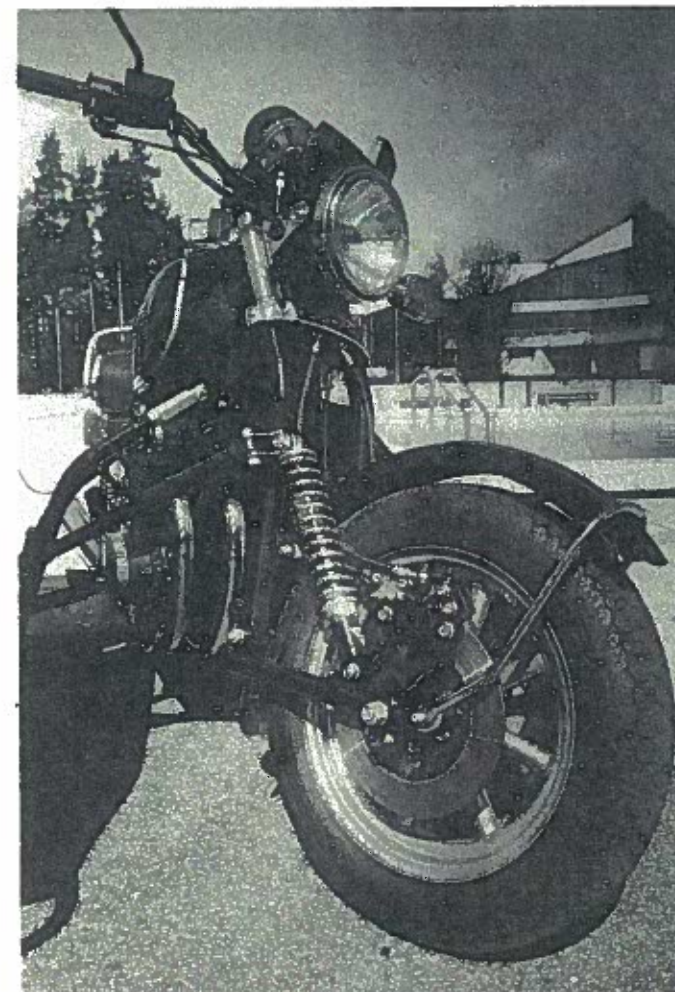
EML:n keinuhaarukajoustettu etupää on sivuvaunukäytössä tukeva ja kevyt ohjata.
